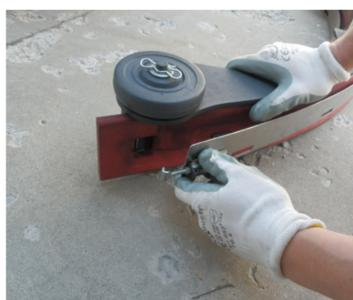
18. Remova o rodo, verifique o estado de desgaste das lâminas e substitua se necessário.
