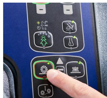
4. Ajuste o padrão da vassoura principal de acordo com o manual do operador para evitar uma condição de sobrecarga. Inspeccione a vassoura e a unidade motriz quanto a sujidades ou ajuste a altura caso seja detetada uma sobrecarga.
