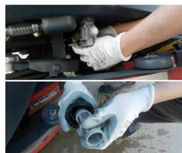
15. Feche a válvula do tanque de água limpa e remova e limpe o filtro. Verifique se as juntas vedantes permanecem na tampa do filtro.
