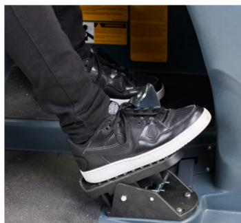
3. O pedal de acionamento deve ser libertado durante o arranque do motor.
