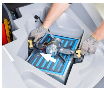
16. Inspeccione e limpe periodicamente o filtro de pó. Substitua se necessário.
