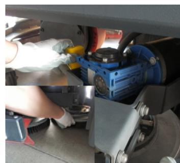
4. Solte a alavanca, abra o suporte da proteção lateral direita e inspeccione as escovas.
