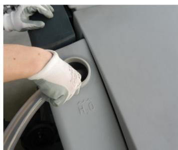
6. Encha o tanque de água do DustGuard™, se a sua máquina estiver equipada com este sistema que pulveriza água para que não se levante pó ao varrer.
