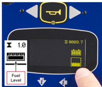
1. Verifique que o sistema de alimentação tem combustível ou bateria suficiente. Se necessário, encha o tanque de diesel/GLP ou carregue as baterias.
