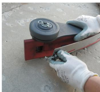
3. Remova e inspeccione as lâminas do rodo.
