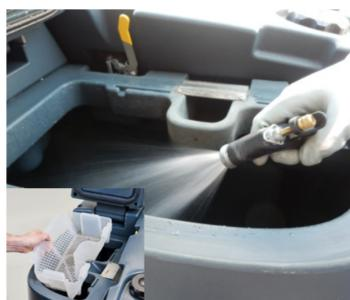
14. Lave com água limpa o depósito de recuperação de água suja. Remova e limpe o tabuleiro de acumulação de detritos.
