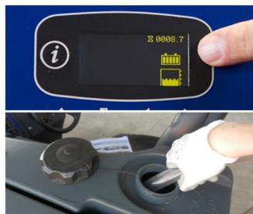
2. Verifique o nível do depósito de água. Se necessário, encha o tanque com água limpa. A temperatura da água limpa não deve ultrapassar os 40 °C.
