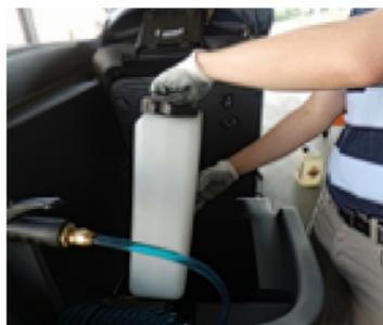
3. Encha o tanque do EcoFlex™, localizado sob o assento, com o detergente de alta concentração adequado. Este sistema proporciona uma maior intensidade de limpeza quando necessário.
