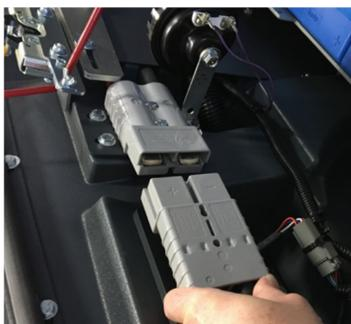
2. Para a versão com bateria, verifique a tensão da bateria e, se necessário, recarregue-a.
