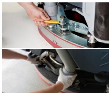
4. Instale o rodo, prenda-o ao seu conjunto e, em seguida, encaixe a mangueira de aspiração ao rodo. Realize os ajustes corretos de altura e inclinação.
