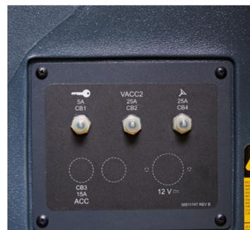
4. Inspeccione os disjuntores.
