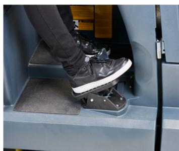
11. Pise o acelerador para começar a limpeza. Se levantar o pé do acelerador, a máquina e a limpeza param.
