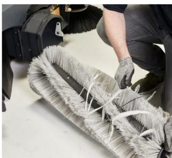
2. Inspeccione a vassoura principal quanto a cordas que podem afetar a rotação.
