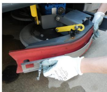
19. Remova as proteções laterais, verifique o estado das lâminas e substitua se necessário.
