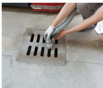
13. Esvazie o depósito de recuperação de água suja com a mangueira. Se a máquina não for utilizada durante um longo período de tempo, esvazie e enxague também o tanque de água limpa.
