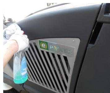
20. Limpe a máquina com um pano húmido e estacione-a com o depósito de recuperação de água suja aberto para secar ao ar.
