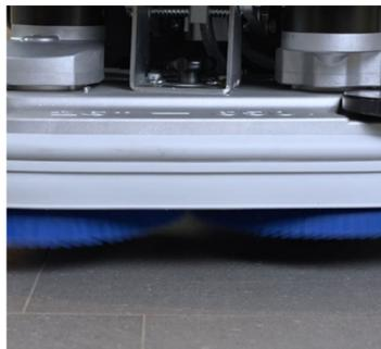
2. Durante il funzionamento, il display mostra: (ALLARME DI AVVERTENZA E17) I motori delle spazzole sono sovraccarichi. Utilizzare spazzole meno aggressive e/o evitare di lavorare con una pressione eccessiva.
