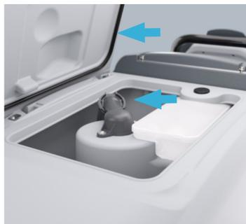
2. Aprire il serbatoio di recupero e controllare che la griglia di aspirazione e la guarnizione siano pulite.
