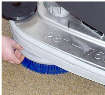
1. Controllare che le spazzole siano installate correttamente e non usurate.
