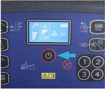
1. Accendere la macchina e digitare il codice predefinito 1, 2, 3 e 4 per verificare che la batteria sia sufficientemente carica per completare il lavoro. Caricare le batterie se necessario.
