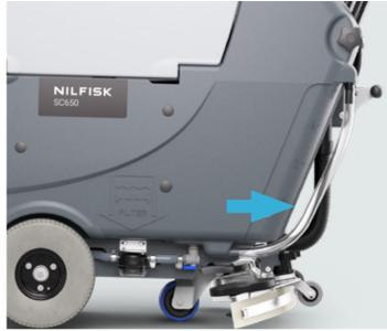
3. Controllare il livello della soluzione sul lato sinistro della macchina.
