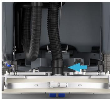
1. Controllare che il cavo di aspirazione sia pulito e installato correttamente.
