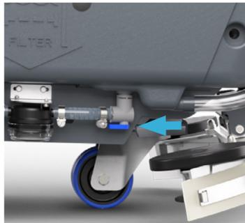
2. Controllare che il rubinetto dell'acqua pulita/della soluzione sia aperto.
