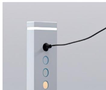
19. Caricare le batterie: Collegare il cavo del caricabatteria alla presa elettrica. I primi due indicatori della batteria inizieranno a lampeggiare, mentre l'ultimo indicatore lampeggerà al termine della carica. L'assenza di lampeggiamento indica che la carica è completa.
