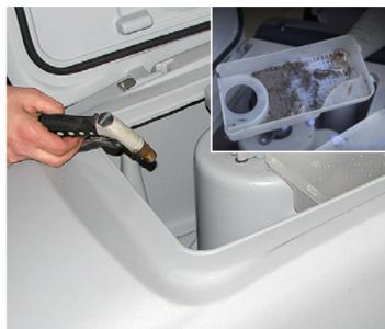
13. Lavare con acqua pulita il serbatoio di recupero e la griglia di aspirazione. Rimuovere, svuotare e pulire il vassoio dei detriti.
