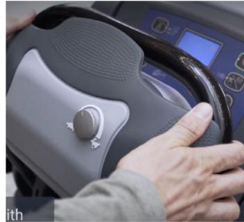
3. La macchina non si muove e il display mostra: (ALLARME DI AVVERTENZA E27) La macchina è accesa con la leva di azionamento premuta. Rilasciare la testata e riprovare.
