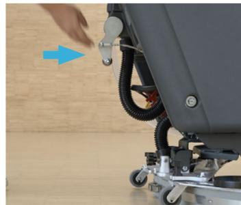
9. Abbassare il tergipavimento tramite la leva.
