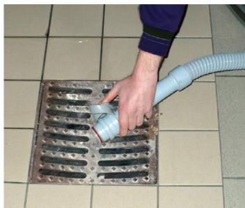
12. Al termine del lavoro. Svuotare il serbatoio di recupero con il tubo flessibile. Piegare la parte morbida prima di togliere il tappo per controllare il flusso.
