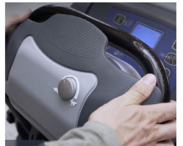
10. Spingere delicatamente la leva di azionamento in avanti per iniziare a pulire, controllare la velocità massima con il selettore di velocità, spingere la leva all'indietro per invertire il senso di marcia.
