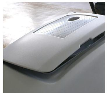
4. Chiudere correttamente il coperchio del serbatoio di recupero e/o verificare che la guarnizione sia funzionante e non presenti perdite d'aria.
