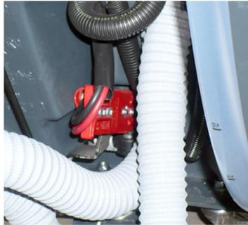
1. Controllare che il cavo elettrico sia collegato correttamente.
