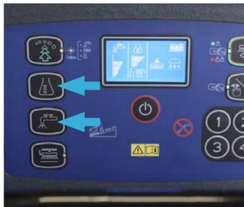
7. Premere i pulsanti di controllo del flusso di soluzione e del detergente, a seconda del tipo di pulizia da eseguire.
