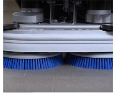
5. Posizionare le spazzole o i supporti del disco sotto la testata. Per pulire il pavimento, usare la spazzola/i dischi adatti.
