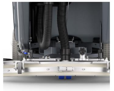
15. Togliere il tergipavimento e pulire. Ispezionare le lame, capovolgerle o sostituirle, se necessario.
