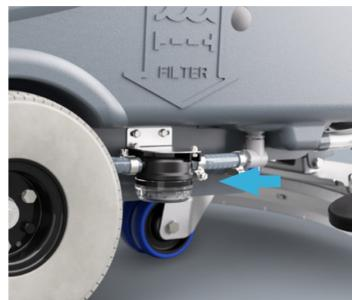
14. Pulire regolarmente il filtro: chiudere la valvola della soluzione sotto la macchina e rimuovere il coperchio trasparente, la guarnizione, quindi rimuovere il filtro. Pulire il filtro e reinstallarlo.
