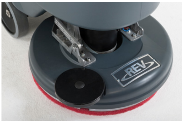
SC500 REV™ pályamenti súrolási technológia: A szennyeződést több irányból támadja meg, tisztább padlót hátrahagyva, csupán egy lépésben
