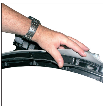
2. Reinigen und prüfen der Absaugleiste und Gummis.
