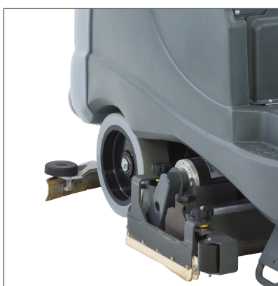
2. Einstellen der Absaugleiste, so dass die Maschine keine Wasserstreifen zieht.
