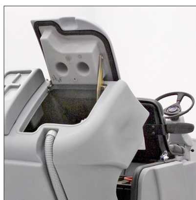
4. Reinigen und Kontrolle des Abwassertanks und Schwimmers.
