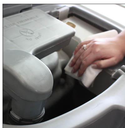
3. Deckel hochklappen und Verunreinigung entfernen.
