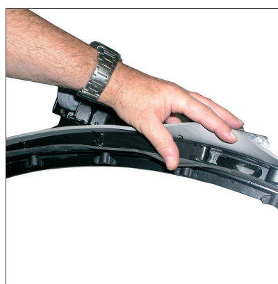
2. Sauglippen auf Verunreinigungen und Zustand prüfen.
