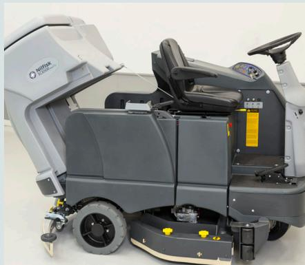
Tip-out 와 lift-off 탱크 시스템으로 손쉽게 폐수처리
