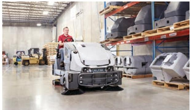
SmartFlow™ 시스템을 통해 물과 화학 물질을 사용하여 장비 속도에 따라 흐르는 양을 조절하며, 탱크의 덤프 / 리필 주기가 줄어 생산성이 높아짐
