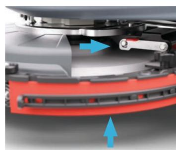
9. Sollevare a mano il tergipavimento fino a bloccarlo in posizione sollevata e disattivare l'aspirazione per il prelavaggio. Per tornare alla modalità normale di lavoro, usare la leva rossa per rilasciare il tergipavimento e riattivare l'aspirazione.
