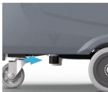
11. Ogni giorno: Svuotare il serbatoio dell'acqua pulita usando la manopola di scarico del serbatoio della soluzione sotto la macchina.
