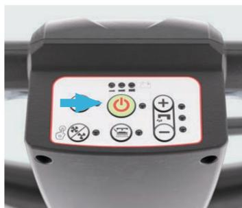
4. Con la macchina accesa, premere uno degli interruttori di sicurezza per inserire la spazzola/il disco trascinatore, poi rilasciarlo. Se necessario, ripetere la procedura finché la spazzola/il disco trascinatore è inserita/o. Il tergipavimento viene sollevato e abbassato con la testata.
