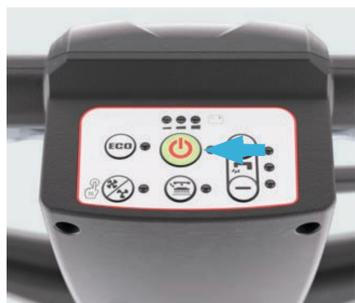
1. Accendere la macchina e verificare che la carica della batteria sia sufficiente per completare il lavoro. Caricare le batterie se necessario.
