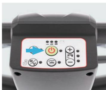
10. Una volta completato il lavaggio, spegnere la macchina per eseguire la seguente manutenzione.
