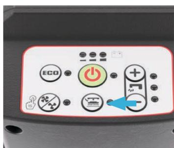
15. Ogni giorno: Con la macchina accesa e la testata sollevata, premere il pulsante di sgancio automatico per rilasciare la spazzola/il disco trascinatore, poi pulire e ispezionare prima dell'utilizzo successivo.
