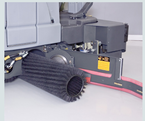
도구 없이 손쉽게 교체 및 조정 가능한 스퀴지와 사이드 블레이드, 브러시로 유지보수가 간단하고 신속
