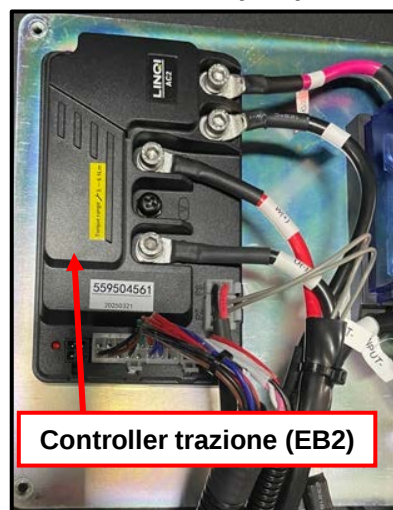
Controller trazione (EB2)
