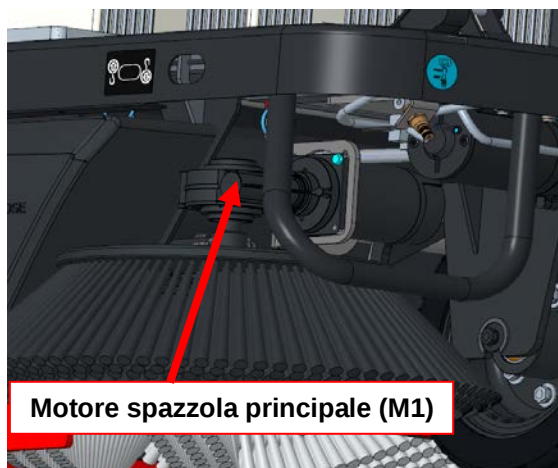
Terminale motore spazzola principale (M1+, M1-) e fusibile spazzola principale (F7: 40A)
