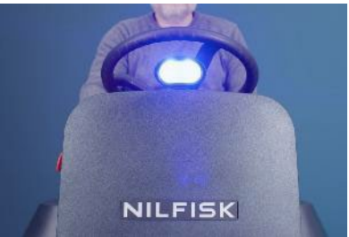
Spot bleu de sécurité qui projette un point lumineux à 4-6 m au sol => la machine peut être repérée dans les angles morts
