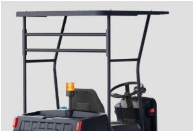
Protège-tête homologué FOPS (intérêt pour les entrepôts de stockage)
