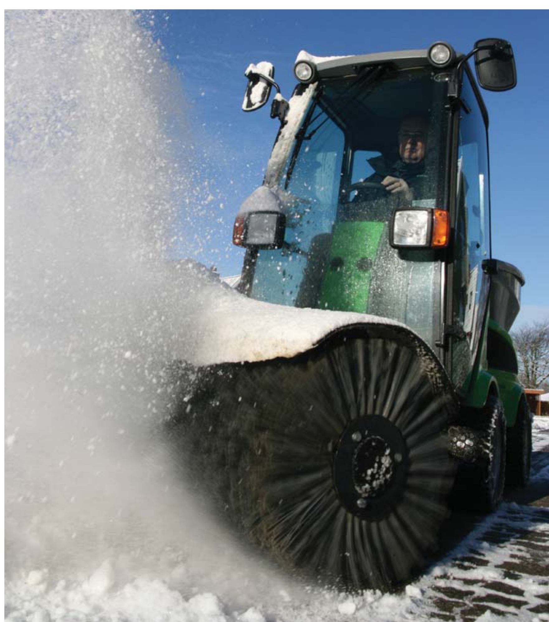
City Ranger 2250 til fejning og støvsugning forår og efterår, plæneklipping om sommeren og snefejning og saltning/grusning om vinteren.
