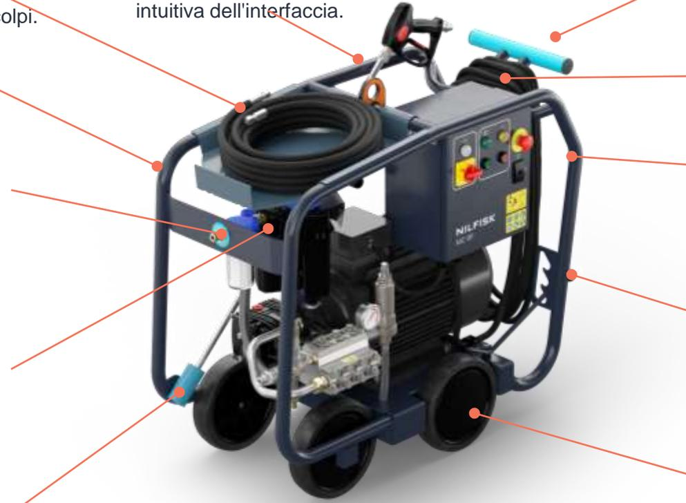
**Manovrabilità:** Impugnatura principale per una movimentazione "Inclinazione e rotazione" ottimale. Impugnatura rimovibile per un facile montaggio/smontaggio del gruppo pompa motore. Colorata per una identificazione intuitiva del punto di contatto principale.
