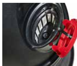
Alimentarea cu apă se face prin deschiderea ovală mare cu filtru și capac de protecție
