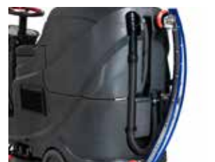
Sistemul de agățat racleta pe bazinul de apă murdară ajută la deplasarea mașinii prin zone înguste
