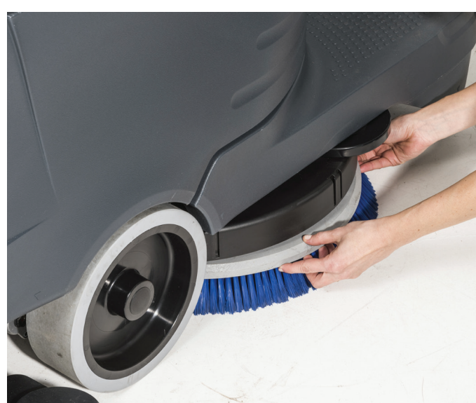
5. Den Bürsten- oder Padhalter unter die Halterung legen und manuell befestigen. Immer eine für den jeweiligen Boden geeignete Bürste verwenden.
