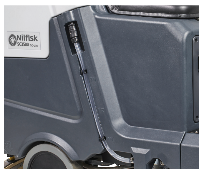
3. Die Anzeige für die Reinigungslösung an der Seite des Behälters zeigt den aktuellen Füllstand an.
