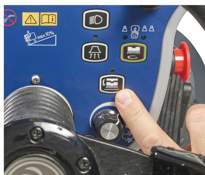
12. Die Click-off-Taste drücken und warten, bis der Bürsten-/Padhalter auf den Boden fällt.
