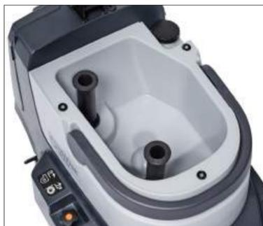
12. Entleeren Sie den Schmutzwasser- und den Frischwassertank. Reinigen Sie beide mit sauberem Wasser.
