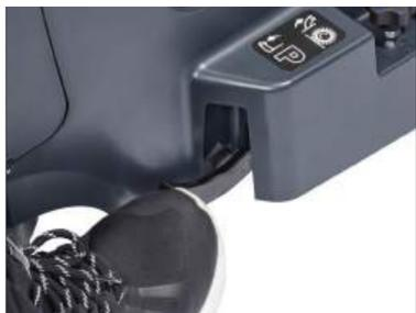
11. Zum Transport und zum Parken, drücken Sie das Pedal nach unten. (Kippen Sie die Maschine hierzu leicht, indem Sie den Schubbügel neigen.)
