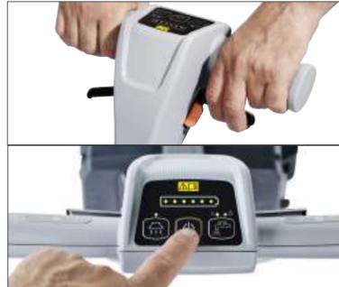
4. Stellen Sie den Schubbügel auf die gewünschte Höhe ein. Schalten Sie die Maschine am Hauptschalter ein.
