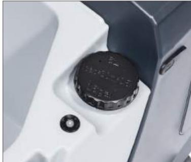
2. Füllen Sie den Frischwassertank mit sauberem Wasser. Die Temperatur darf nicht höher sein als 40 °C.
