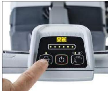
9. Zum Vorlegen drücken Sie die Taste zum Ausschalten der Absaugung. Im zweiten Arbeitsgang die Absaugung wieder anschalten.
