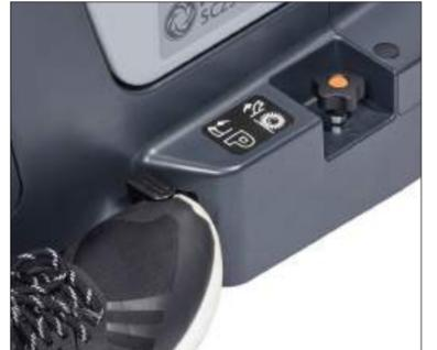
5. Heben Sie das Pedal an, um die Maschine abzusenken und beginnen Sie zu arbeiten.
