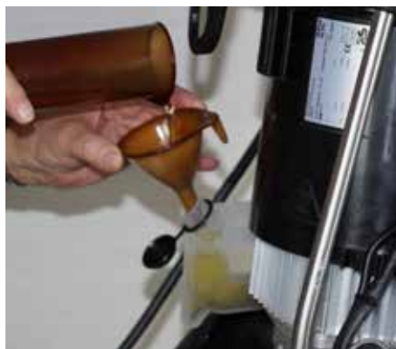
펌프 오일 탱크 - 오일 레벨 확인과 주입·배출이 간편해 유지보수 시간 단축 및 효율적 관리
