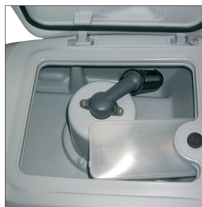
3. Abwassertank – Dichtung prüfen und ggf. reinigen.
