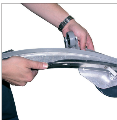
2. Sauplippen auf Verunreinigungen und Zustand prüfen.
