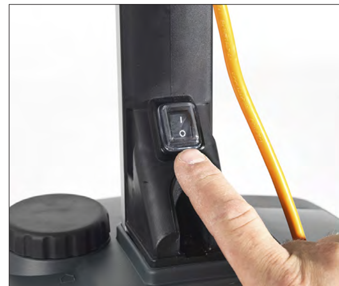
5. Tænd gulvvaskeren ved at stille hovedafbryderen på "I".
