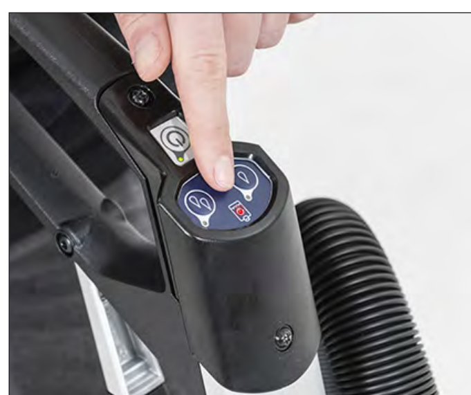
11. Den røde diode blinker når rentvandstanken er ved at være tom og lyser konstant når den er helt tom. Tøm snavsevand og påfyld rent vand, maskinen er klar til brug igen.
