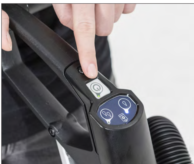
7. Når maskinen er i arbejdsposition trykkes på start tasten og rengøring påbegyndes. Maskinen stopper automatisk når den parkeres opretstående.
