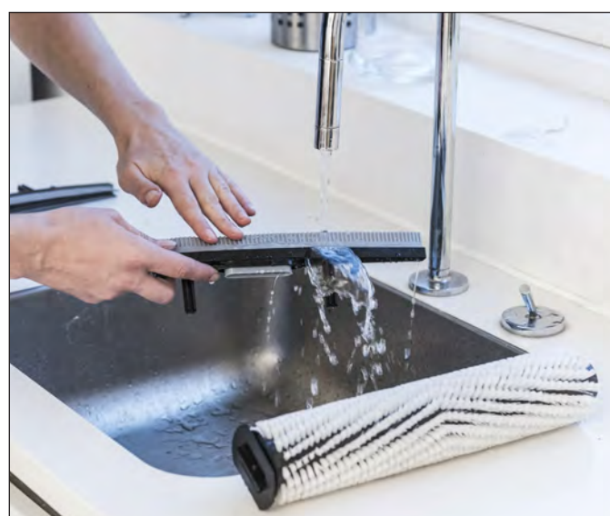
19. Rengør sugefod og børste med rent vand.
