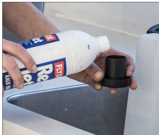
3. Låget fra tanken kan bruges til dosering af kemi. 1 låg svarer til 30ml hvilket giver 1% rengøringsmiddel i de 3L tank. (*)
