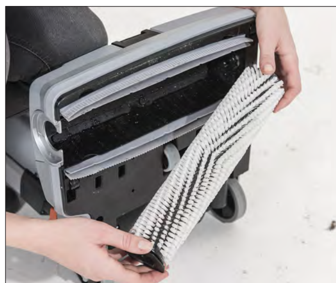
18. Afmonter børsten ved at skrue med uret.
