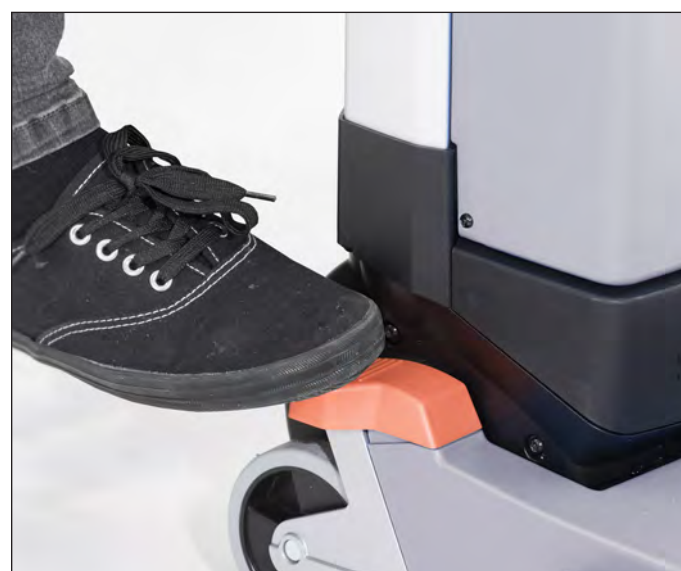
6. Tryk på den orange fodpedal for at sænke maskinen til arbejdsposition.
