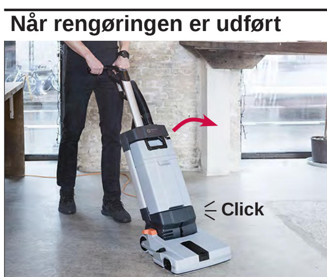
13. Parker maskinen i opretstående position. Stil hovedafbryderen på "0".
