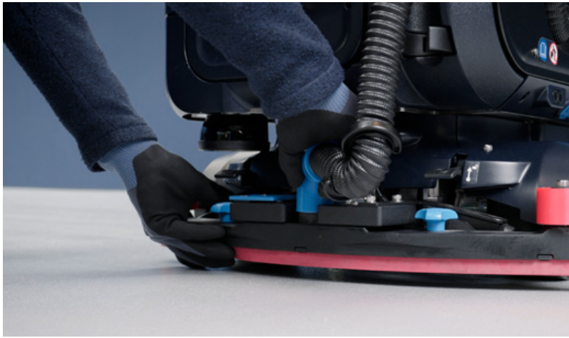
6. Entfernen Sie die Saugleiste und den Saugschlauch. Reinigen Sie die Sauglippen und stellen Sie sicher, dass die Saugöffnung an beiden Enden frei von Verstopfungen ist.
