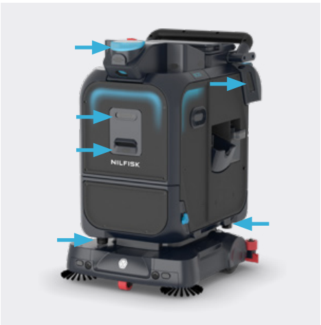
1. Überprüfen und reinigen Sie alle optischen Sensoren mit einem Mikrofasertuch (den oben befindlichen 3D-LiDAR-Sensor nur, sofern vorhanden).
