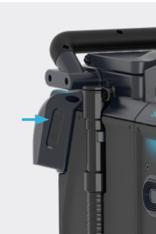
1. Überprüfen und reinigen Sie alle optischen Sensoren mit einem Mikrofasertuch (den oben befindlichen 3D-LiDAR-Sensor nur, sofern vorhanden).
