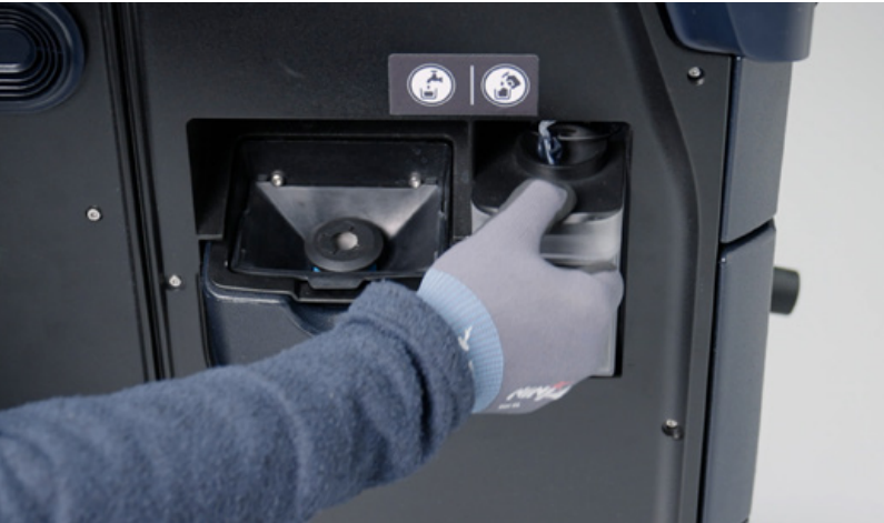
5. Befüllen Sie den Chemikalien-tank mit einem für Scheuersaugmaschinen geeigneten Reinigungsmittel.
