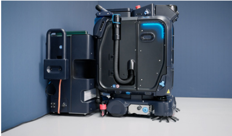
7. Die Dockingstation sorgt automatisch für das Auffüllen des Frischwassertanks und das Aufladen der Batterie.
