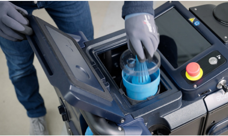
5. Entleeren Sie den Schmutzfangkorb und spülen Sie den Tank mit Wasser aus.
