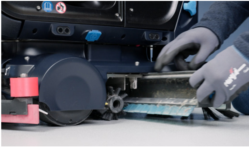
7. Reinigen Sie die Schmutzauffangwanne sowie die Haupt- und Seitenbürsten.
