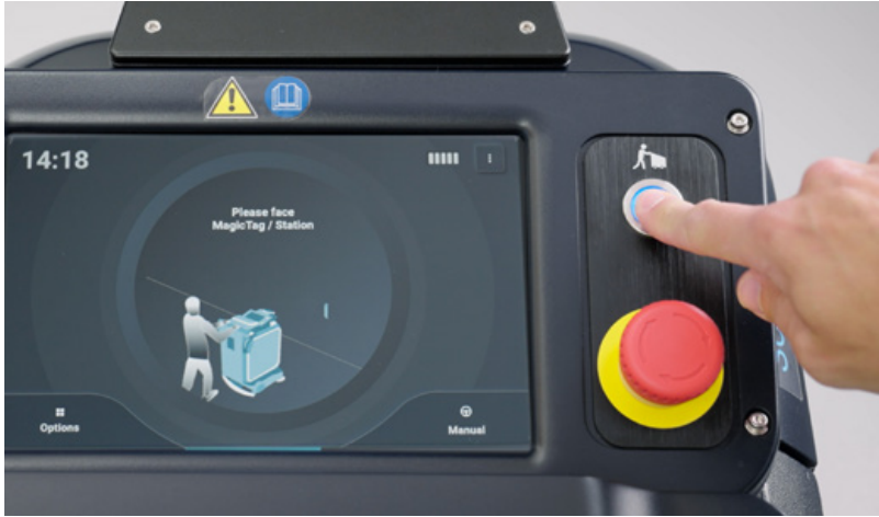
3. Drücken Sie die Bremsen-riegelung, um die Maschine manuell zu bewegen.
