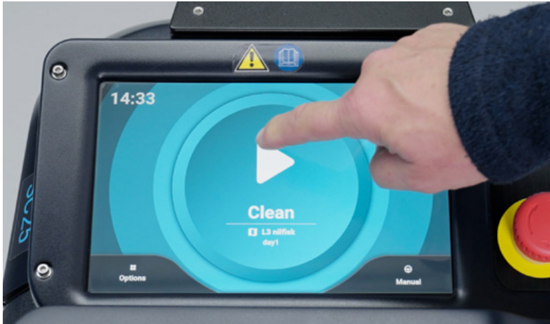
6. Wählen Sie den Reinigungsplan in der rechten Liste aus und drücken Sie auf „Reinigen“. Die Maschine fährt nach Abschluss automatisch zur Dockingstation zurück.
