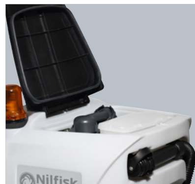
Teljesen levehető gyűjtőtartály-fedél az egyszerű tisztításért
