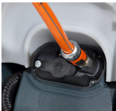
Sistem de alimentare cu oprire automată după umplerea rezervorului (opțional)
