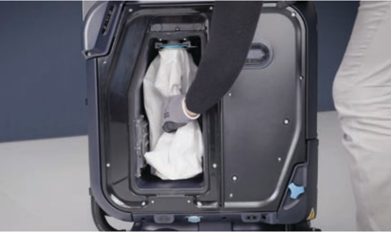
5. Prüfen Sie, ob der Staubbeutel nicht voll ist, und tauschen Sie ihn bei Bedarf aus.
