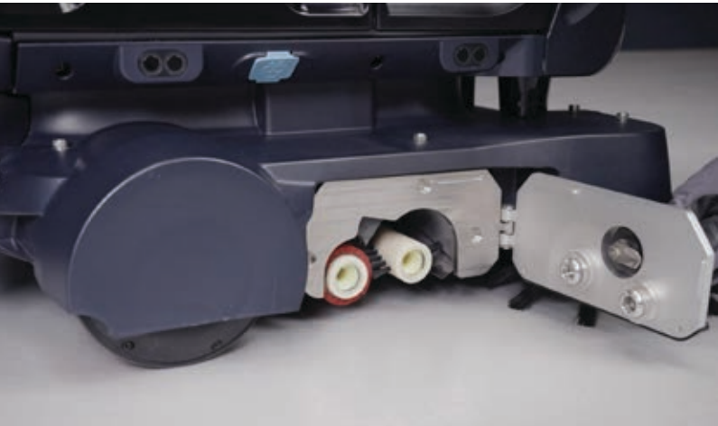
5. Reinigen und überprüfen Sie die Zylinderbürsten und ersetzen Sie diese, wenn sie beschädigt oder abgenutzt sind.
