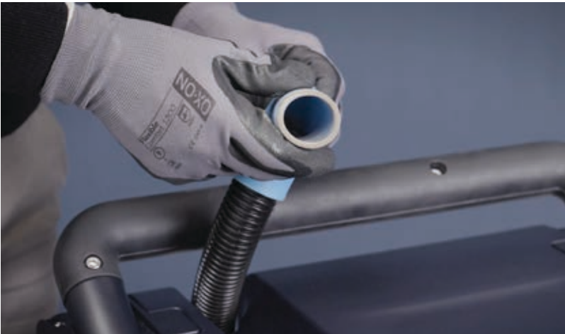
7. Prüfen Sie bei Bedarf oder mindestens einmal pro Woche, ob der Saugschlauch verstopft ist.
