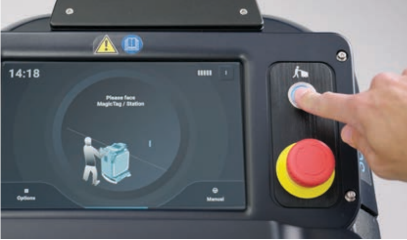
3. Drücken Sie die Bremsenentriegelung, um die Maschine manuell zu bewegen.
