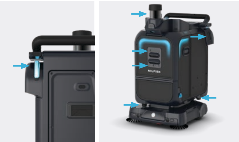
1. Überprüfen und reinigen Sie alle optischen Sensoren mit einem Mikrofasertuch (den oben angebrachten 3D-LiDAR-Sensor nur, sofern vorhanden).
