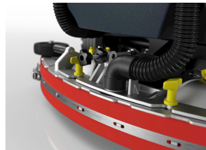
5. Sjekk at nalbladene ikke har noen skader og installer nalen ved å vri på de gule knottene. Sjekk høyden på nalen ved å justere på hjul og vinkelbryter.
