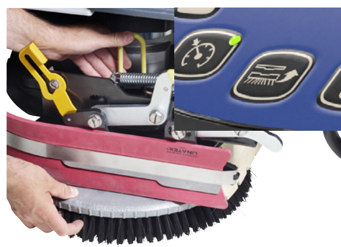
6. Press guide-spaken fremover samtidig som du skyver børsten inn under dekket, stopp når børsten er i kontakt med begge benene på guide-spaken. Repeter dette steget for børsten på den andre siden av dekket. Skru På maskinen og trykk på Click On-knappen (kun disk versjon).
