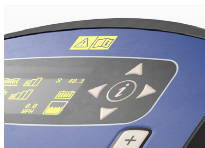
11. Trykk på „i” og bla ned til feil, trykk på „>” knappen for å se feil om nødvendig.
