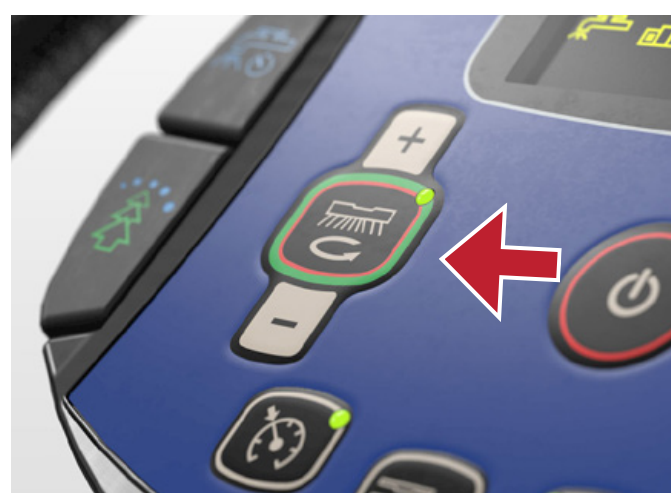
9. Trykk på One Touch-knappen for å aktivere børstedekket og nalen.
