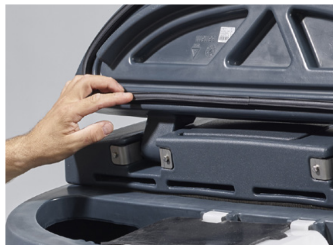
4. Forseglingen til dekselet på oppsamlingstanken må være riktig installert og i god stand.
