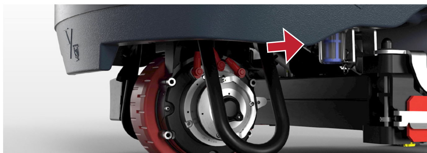
16. Rengjør filteret: A) Lukk løsningsventilen under maskinen. B) Fjern det transparente dekslet og pakningen, fjern og rengjør deretter filteret inni, med rent vann. C) Sett sammen filteret igjen.
