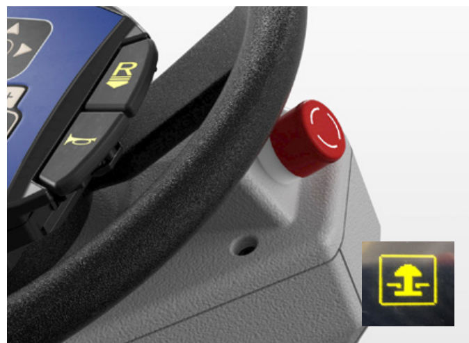
2. Dette ikonet vises på skjermen når E-stop-bryteren er aktivert. Vri E-stop-bryteren for å aktivere maskinfunksjonen.
