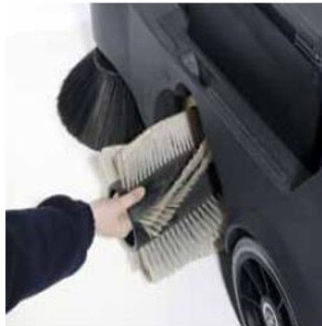
필터와 브러시는 서비스 및 교체를 위하여 도구없이 빠르고 쉬운 접근 가능
