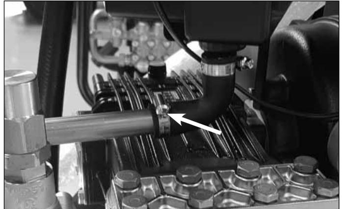
Passo 2: Desaperte o grampo da mangueira que fixa o ângulo de borracha dobrado ao tubo de aço, rode o sentido do ângulo de borracha para a frente e aperte novamente o grampo da mangueira.
