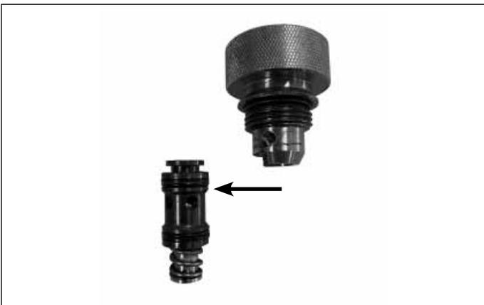
Utilizando apenas os dedos, solte lateralmente o conjunto do cartucho da ranhura de retenção na extremidade inferior da porca do cartucho. Lubrifique os anéis e os vedantes. Para montar, basta inverter o processo.
