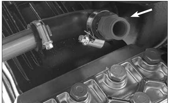
Passo 4: Monte um encaixe adequado no ângulo de borracha e reposicione a mangueira de alimentação de água neste local. A pressão da alimentação de água deve ser de 2-3 bar.
