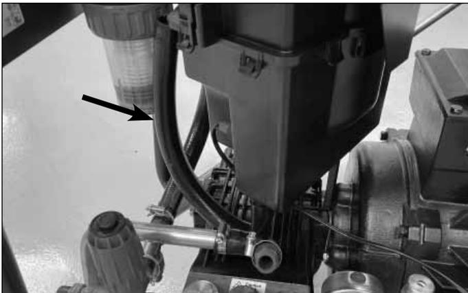
Passo 3: Bloqueie a porta de saída do WBT com uma mangueira curta e rode a mangueira para cima. Reabasteça o WBT até que o interruptor de nível no WBT fique engatado, permitindo que a VHPW arranque novamente.
