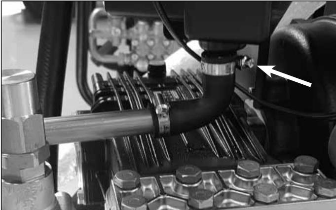
Passo 1: Solte o grampo da mangueira no ângulo de borracha dobrado à saída do WBT e desligue os dois. Se o WBT estiver cheio, a água verterá sobre a bomba.
