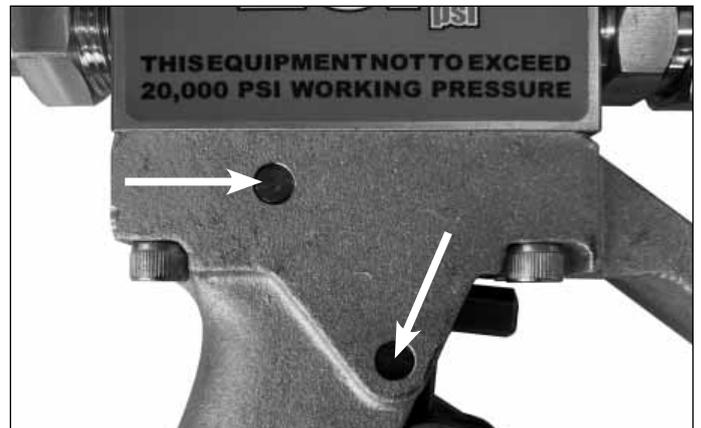
Depois de voltar a montar o conjunto do cartucho, o gatilho tem de ser desmontado para lubrificação. Utilize um mandril para bater nos pinos a partir do lado mostrado na imagem anterior. (Nota: Verifique se está a retirar os pinos do lado correto, certificando-se de que o texto "Drive pin out this side" (Pino de acionamento fora deste lado) NÃO aparece).
