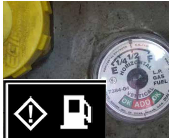
1. Kontroller niveauet på Diesel tank / LPG beholder. Om nødvendigt påfyld brændstof.
