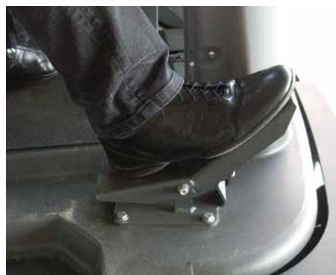
11. Tryk på gaspedalen og maskinen er klar til brug. Alle funktioner bliver aktiveret når gaspedalen bevæges. (Frem og bak med samme pedal)
