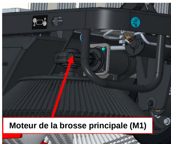
Borne du moteur de la brosse principale (M1+, M1-) et fusible de la brosse principale (F7 : 40A)
