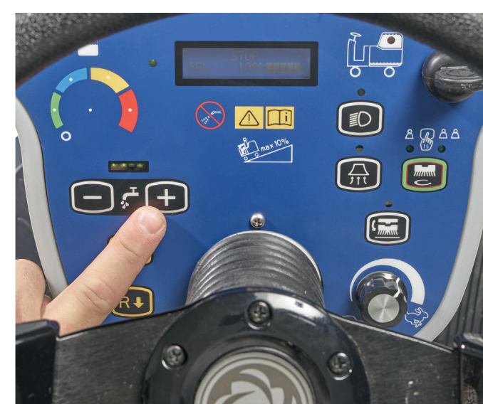
9. Still inn (hvis nødvendig) nivået for rengjøringsmiddeldosering i overensstemmelse med rengjøringseffekt og bruk.
