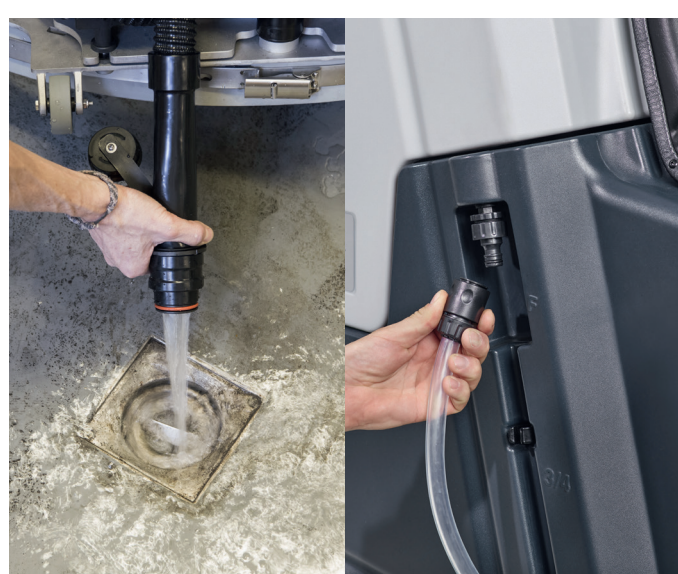
10. Når du har avsluttet rengjøringen, må du tømme skittenvannstanken med slangen. Tøm deretter rentvannstanken med den gjennomsiktige slangen.
