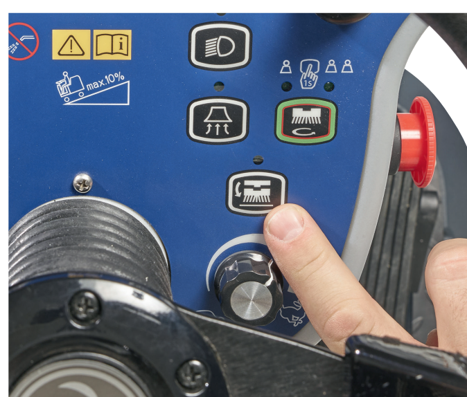
12. Trykk på knappen for å utløse børsten, og vent til børste-/padholder faller ned på gulvet.
