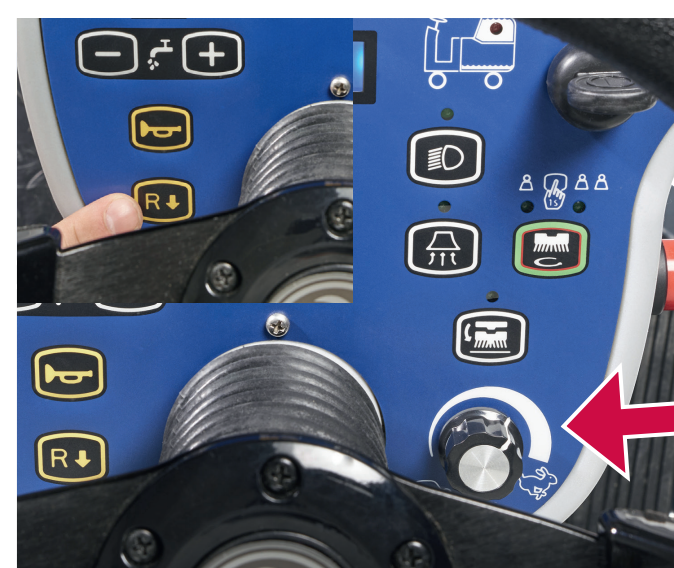
8. Trå på gasspedalen for begynne rengjøringen. Still inn rengjøringsmaskinens maksimale hastighet ved hjelp av hastighetsbryteren. For å kjøre bakover, trykk på R på betjeningspanelet.
