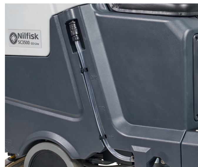
3. Indikatoren på siden av beholderen viser den aktuelle mengde av rengjøringsmiddel.
