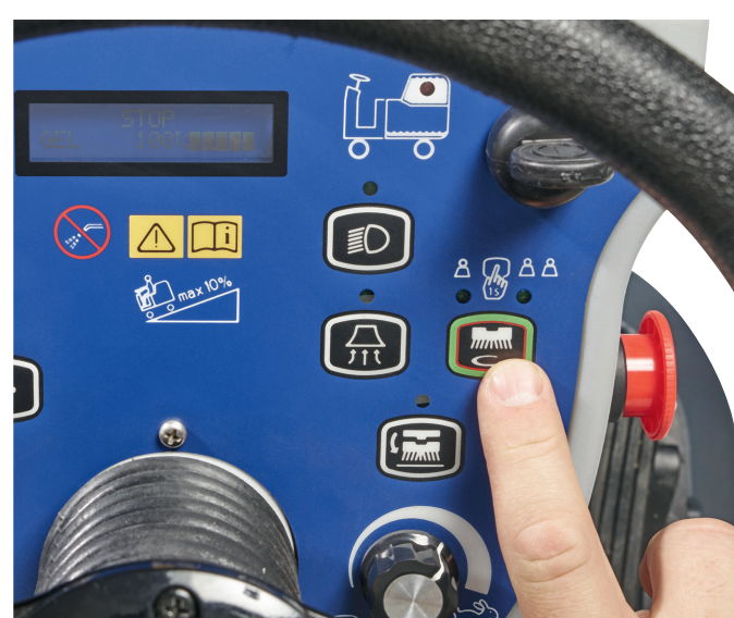
7. Sett operatørnøkkelen i, og start gulvvaskeren. Senk børsten ved å trykke på børsteknappen.
