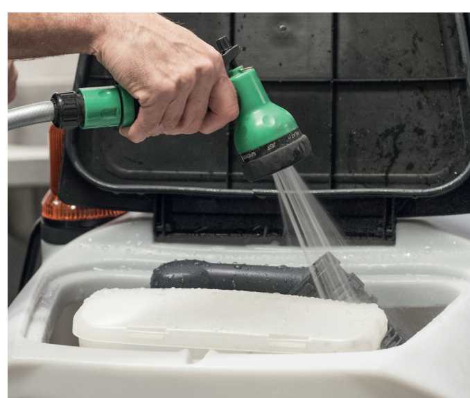
11. Vaske skittenvannstanken og grovfilteret med rent vann.
