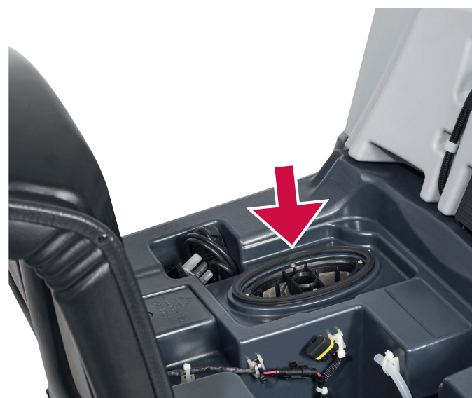
2. Fyll rentvannstanken med rent vann. Vannets temperatur må ikke overstige 40°C.
