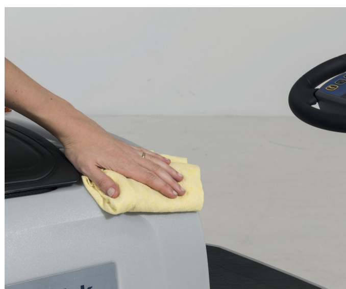
15. Rengjør gulvvaskeren med en fuktig klut og et nøytralt rengjøringsmiddel hvis det er nødvendig.
