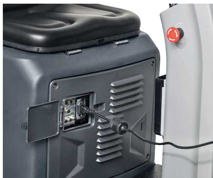
1a. Ta ledningen ut av gulvvaskeren og legg kabelen vekk.
