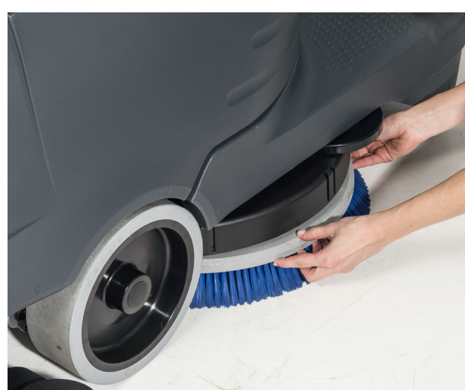
6. Plasser børsten eller padholderen under dekket, og monter den manuelt. Bruk en passende børste til rengjøring av gulvet.
