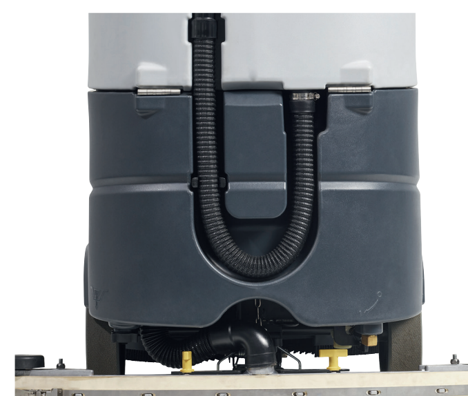
14. Ta sugenalen av og fjern skitt. Kontroller og rengjør sugenalens nalgummi.
