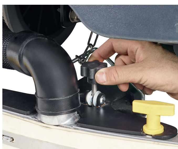
5. Justér sugenalens vinkel og naltrykk, så mest mulig vann suges opp.
