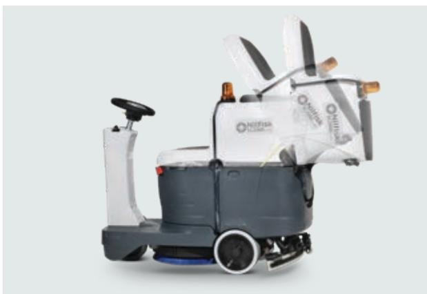
Depósito de recuperação totalmente inclinável que facilita o acesso ao compartimento de baterias e sistema EcoFlex™.
