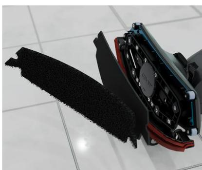
4. Fissare il feltro per pavimenti a MAGPlate.
