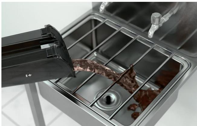
3. Tenendo il serbatoio con due mani, svuotare il liquido di recupero in modo appropriato
