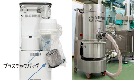
使用済み吸気 HEPA フィルターを取り外した状態
